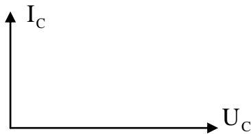
Рис. 64. Векторная диаграмма для емкости C .
